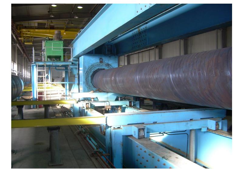
• Стенд для проведения гидроиспытаний.
