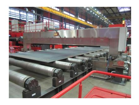
Система «CHECK-SOFT Plate-TLWF» предназначена для измерений геометрических параметров листов стали при проведении входного контроля на производстве труб большого диаметра
