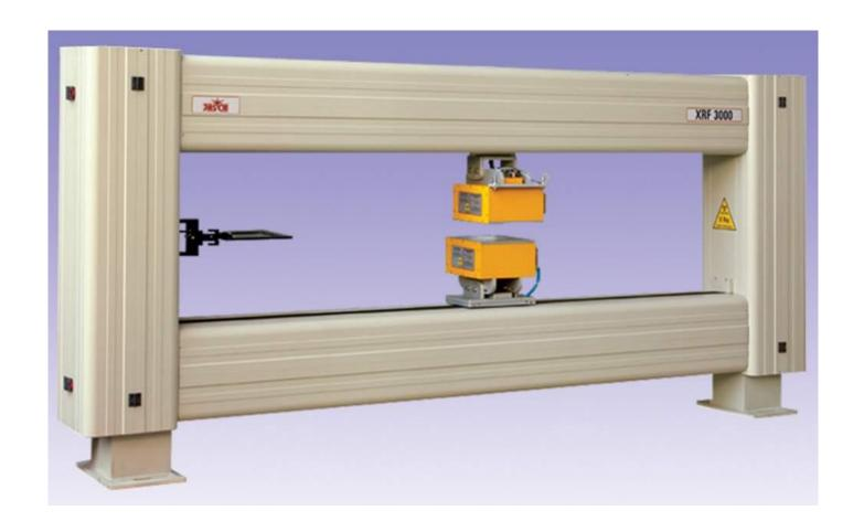
• Измерение толщины покрытия
