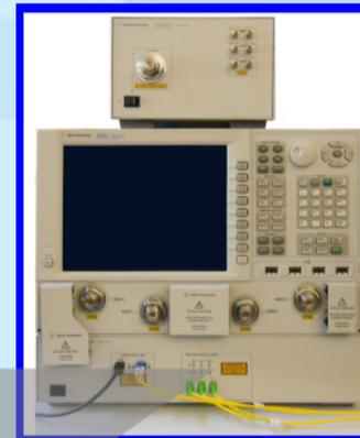
Система для измерения параметров антенн с оптическими расширителями
