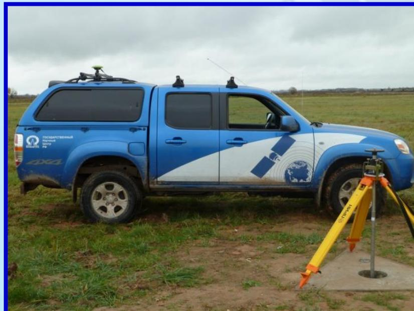
*Определение точностных характеристик спутниковой геодезической аппаратуры (погрешность измерений расстояния в диапазоне от 500 м до 30000 м составляет от 0,005 м до 0,02 м);*
