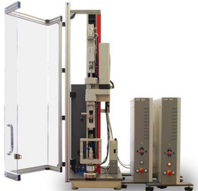
Роботизированная система ,roboTest R' с торсионной машиной на 2.5 кН для функциональных испытаний инсулиновых картриджей
