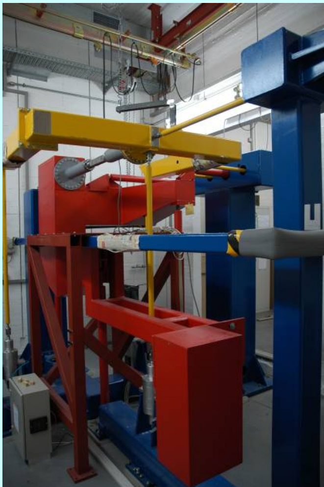
Автоматизированный градуировочный стенд для метрологической отработки тензовесов класса точности 0,05...0,1
